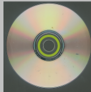
Fragilidade dos suportes: falha na metalização de CD-ROM (INNARELLI, SOLLERO)
